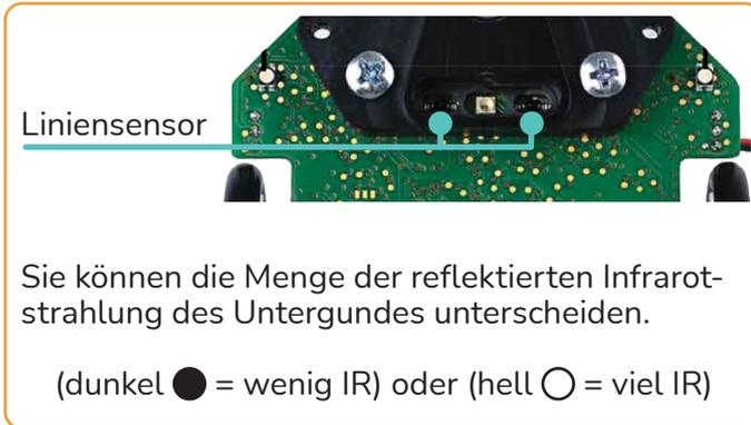
Lass den Calli:bot nach links fahren, wenn der Infrarotsensor eine schwarze Linie entdeckt.
